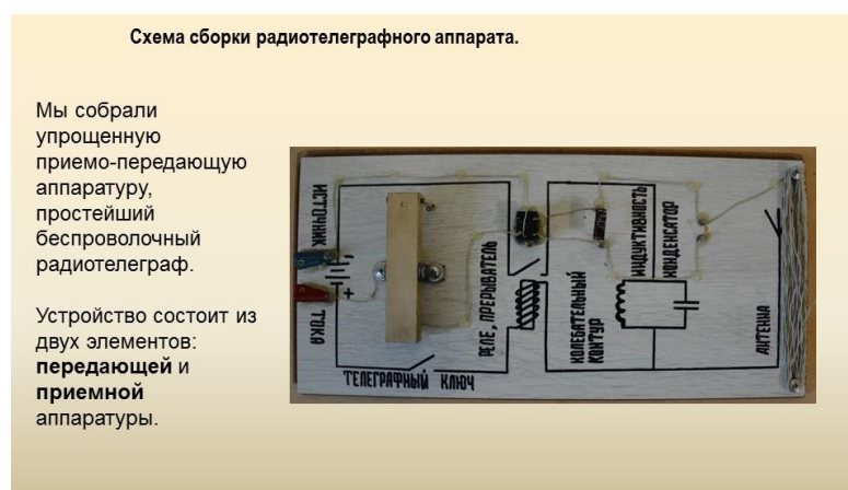
Фото 2. Упрощенный приемопередающий беспроводный аппарат для изучения азбуки Морзе
